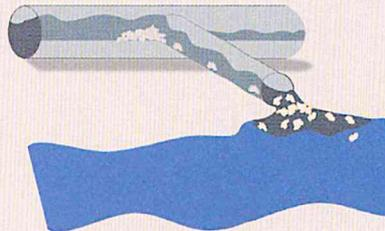
Ainsi, l'accumulation des lingettes dans les canalisations peut entraîner des obstructions et des déversements d'eaux usées dans la rivière.
